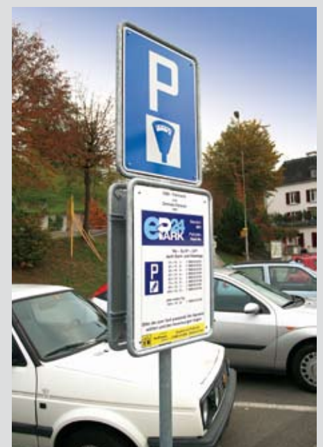
Variante mit doppelseitigen Schildern (Rohrrahmen mit Jordahlschienen)
